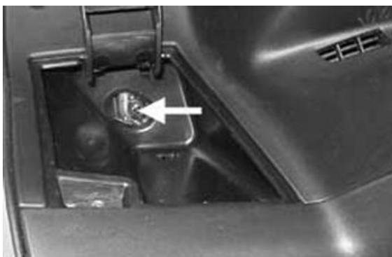
Togliere il faro rimuovendo il connettore elettrico del proiettore e il portalamпада della luce di posizione completo di lampadina.
