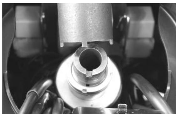
Inserire il collarino in figura e ripristinare il passaggio cavi come mostrato in figura.
