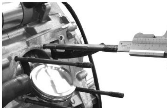
Mediante due dadi di fissaggio testa montati tipo dado e controdado come indicato in foto rimuovere il prigioniero dalla propria sede.
