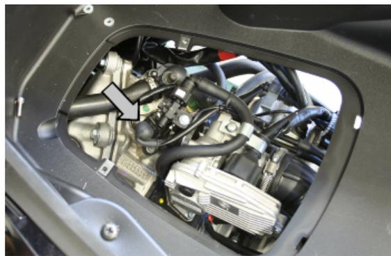
Rimuovere le 3 viti di fissaggio collettore alla testa e la fascetta di fissaggio corpo farfallato al collettore.
