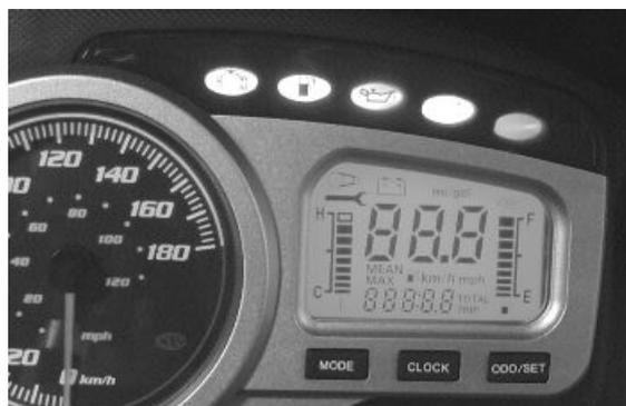
La sezione digitale del cruscotto si completa con un display a cristalli liquidi e 3 pulsanti di comando (MODE - CLOCK - ODO/SET).
