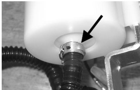
Allontanare la parte inferiore del supporto pompa come indicato in foto.
