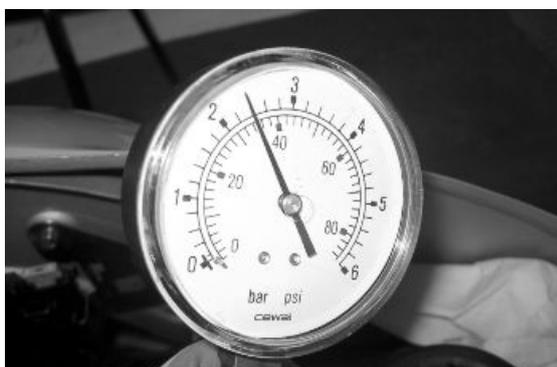
Procedere con la prova di tenuta dell'iniettore. Asciugare l'uscita dell'iniettore con un getto d'aria compressa. Attivare la pompa della benzina. Attendere un minuto, verificare che non siano presenti perdite dall'uscita dell'iniettore. Un leggero trasudamento è normale.
