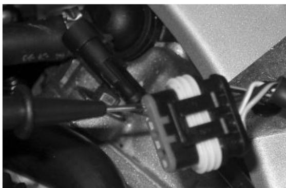
iniezione scollegato, che il cavetto Nero-Viola (pin 20 sul cablaggio interfaccia) sia isolato da massa.
