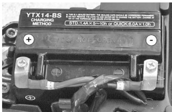
Accertarsi del corretto collegamento dei morsetti. Alla messa in servizio di una nuova batteria deve essere ripristinata l'ora e la data corretta sullo strumento digitale (sezione «Orologio» e «Tasto MODE»).
