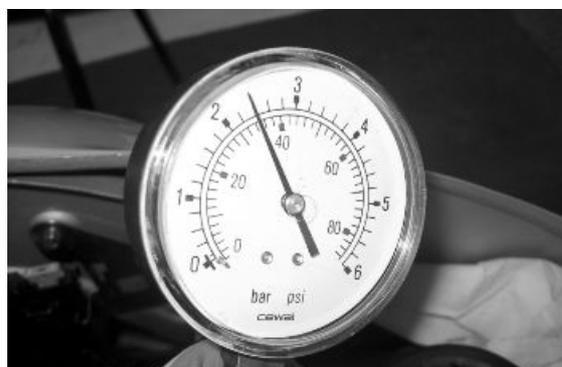
A tensione batteria > 12 V, verificare la portata della pompa scollegando il tubo munito di manometro dell'attrezzo specifico dall'iniettore. Predisporre una buretta graduata con capacità di circa 1 L. Far ruotare la pompa mediante le diagnosi attive del palmare. Mediante un paio di pinze a becchi lunghi e piatti strozzare il tubo carburante facendo stabilizzare la pressione a circa 2,5 BAR. Verificare che in 15 secondi la pompa abbia una portata di circa 110cc.
