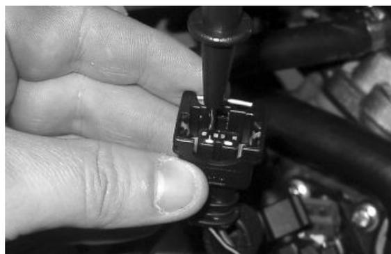
Verificare, a iniettore scollegato e teleruttore carichi iniezione scollegato, la continuità del cavetto Nero-Verde tra connettore iniettore e zoccolo teleruttore.
