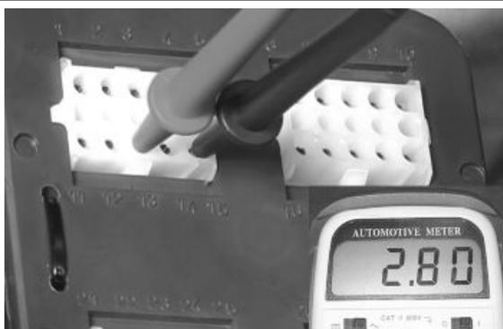
Con cablaggio interfaccia scollegato dalla centralina verificare la continuità tra il pin 13 e il cavetto rosso del connettore sensore giri e tra il pin 15 e cavetto bianco del connettore sensore giri
