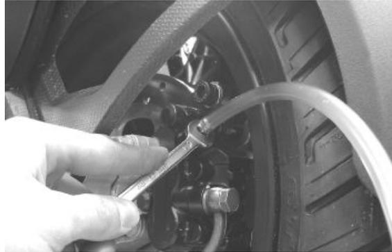
In caso di necessità è possibile eseguire lo spurgo anche mediante pompa a depressione specifica
