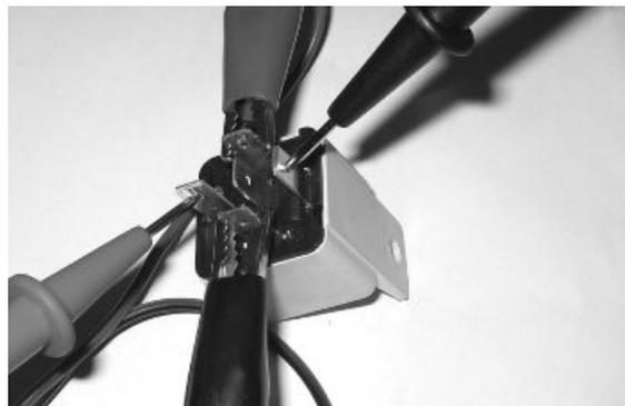
Verificare la linea di alimentazione della bobina di eccitazione teleruttore carichi iniezione: commutando in "ON" verificare la presenza di tensione batteria, per 2 secondi, tra ed il cavetto Nero-Bianco e Nero-Viola dello zoccolo teleruttore. In caso contrario verificare la continuità del cavetto Nero-Bianco tra la scatola porta fusibili e lo zoccolo teleruttore e del cavetto Nero-Viola tra il pin 20 della centralina e lo zoccolo del teleruttore.
