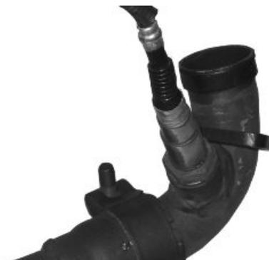
**ATTENZIONE: QUALORA SIA NECESSARIA SOLAMENTE LA RIMOZIONE DEL TERMINALE DELLA MARMITTA, SI PROCEDA SEMPRE CON LA SOSTITUZIONE DELLA GUARNIZIONE IN GRAFITE TRA TRONCHETTO E TERMINALE.**
