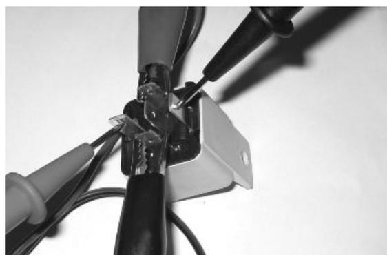
Verificare la linea di alimentazione della bobina di eccitazione teleruttore carichi iniezione: commutando in "ON" verificare la presenza di tensione batteria, per 2 secondi, tra ed il cavetto Nero-Bianco e Nero-Viola dello zoccolo teleruttore. In caso contrario verificare la continuità del cavetto Nero-Bianco tra la scatola porta fusibili e lo zoccolo teleruttore e del cavetto Nero-Viola tra il pin 20 della centralina e lo zoccolo del teleruttore.
